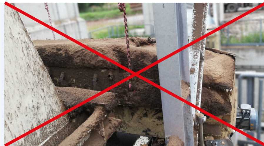
Figure : Aimant overband avec d'importantes couches de poussières Un aimant propre fonctionne beaucoup plus efficacement qu'un aimant contaminé.
